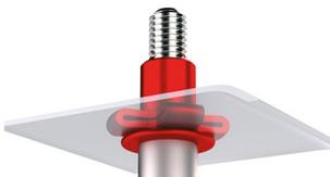
Регулировка стика производится без антиспильной трубки. При закрытом капоте головка стика должна находиться на расстоянии от 1 до 6 миллиметров ниже корпуса, в противном случае контроллер замка не получит разрешающий сигнал на закрытие.
